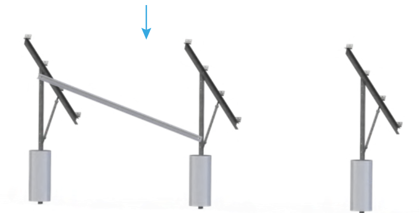
Figura 13 - Reforço de contraventamento
