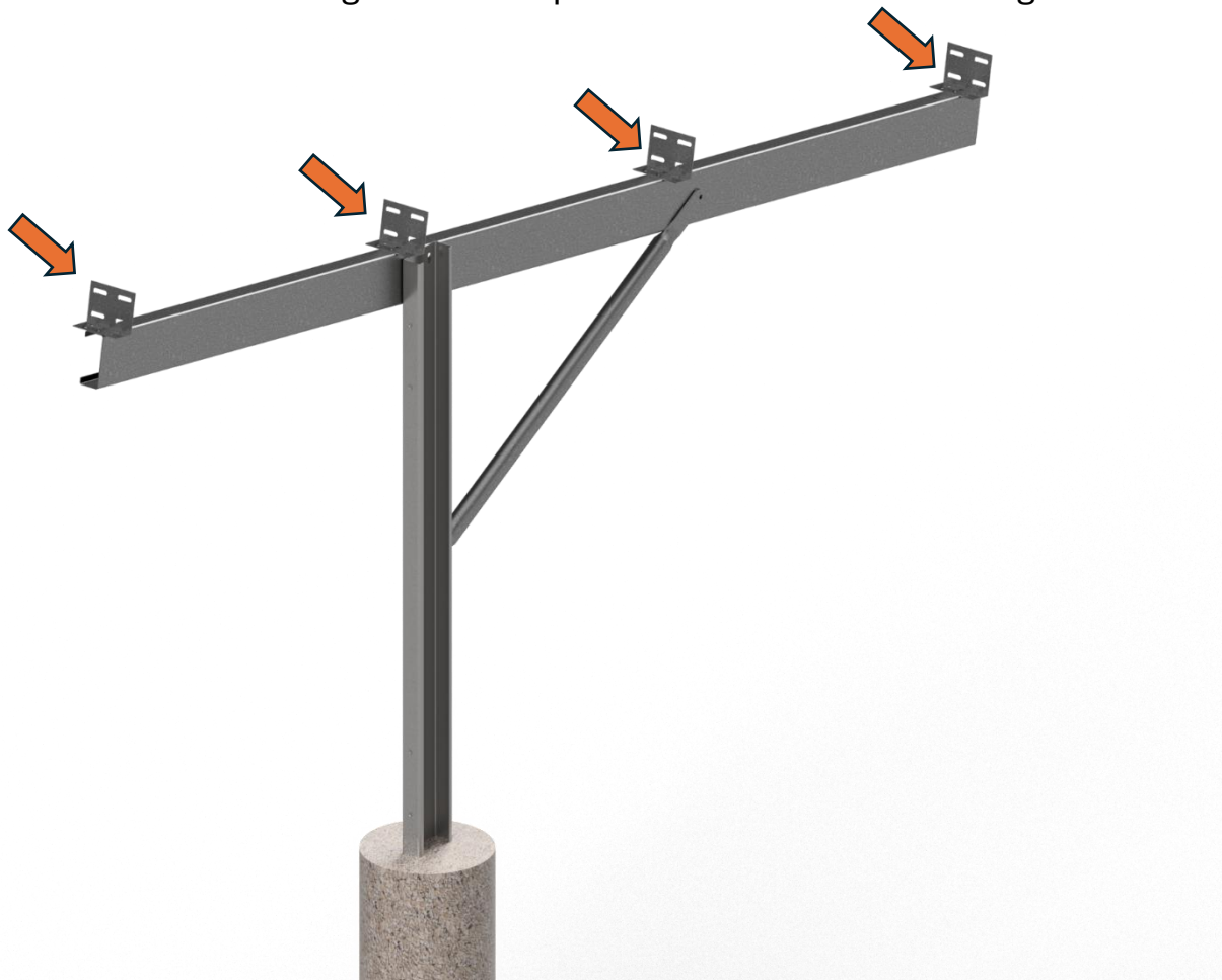
Figura 11 - montagem dos suportes das terças
